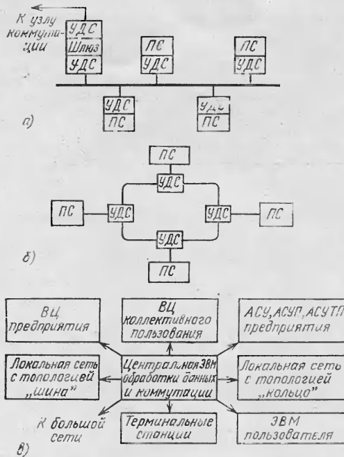
Рис. 2. Основные типы топологий ЛВС: а — шина, б — кольцо, в — звезда ПК — пользовательская система; ВЦ — вычислительный центр; УДС — устройство доступа к среде
