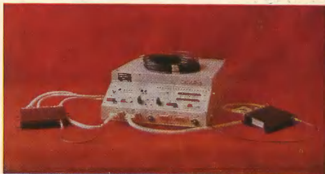
Стенд цехового автоматизированного контроля изделия «Электроника МС 4101»
